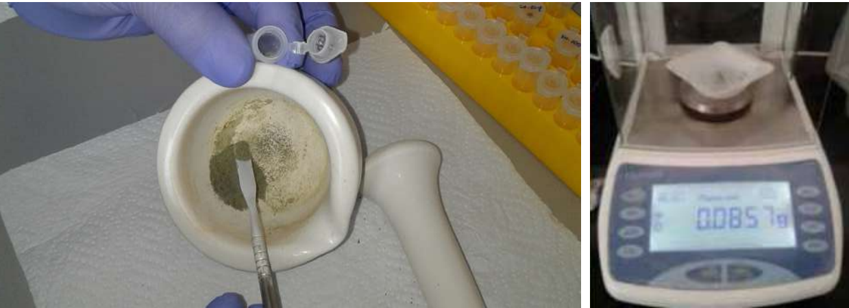
Figura 2. Medición del peso del material vegetal triturado en una balanza analítica.
