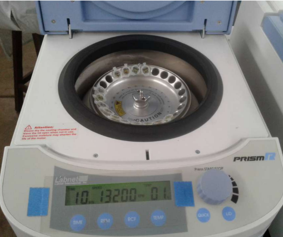
Figura 10. Proceso de centrifugación para la separación del ADN con los diferentes restos durante el proceso de extracción.
