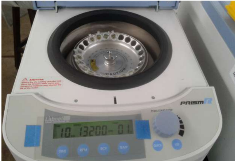
Figura 5. Proceso de centrifugación para lograr separar la muestra en dos fases.
