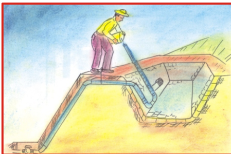
Figura N° 6: Operación para el funcionamiento del sifón
